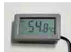
送風口に温度計を設置 測定した結果、最高温度は 54.8℃
